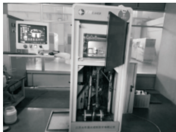
图 2 YLM-120 SLM 设备
